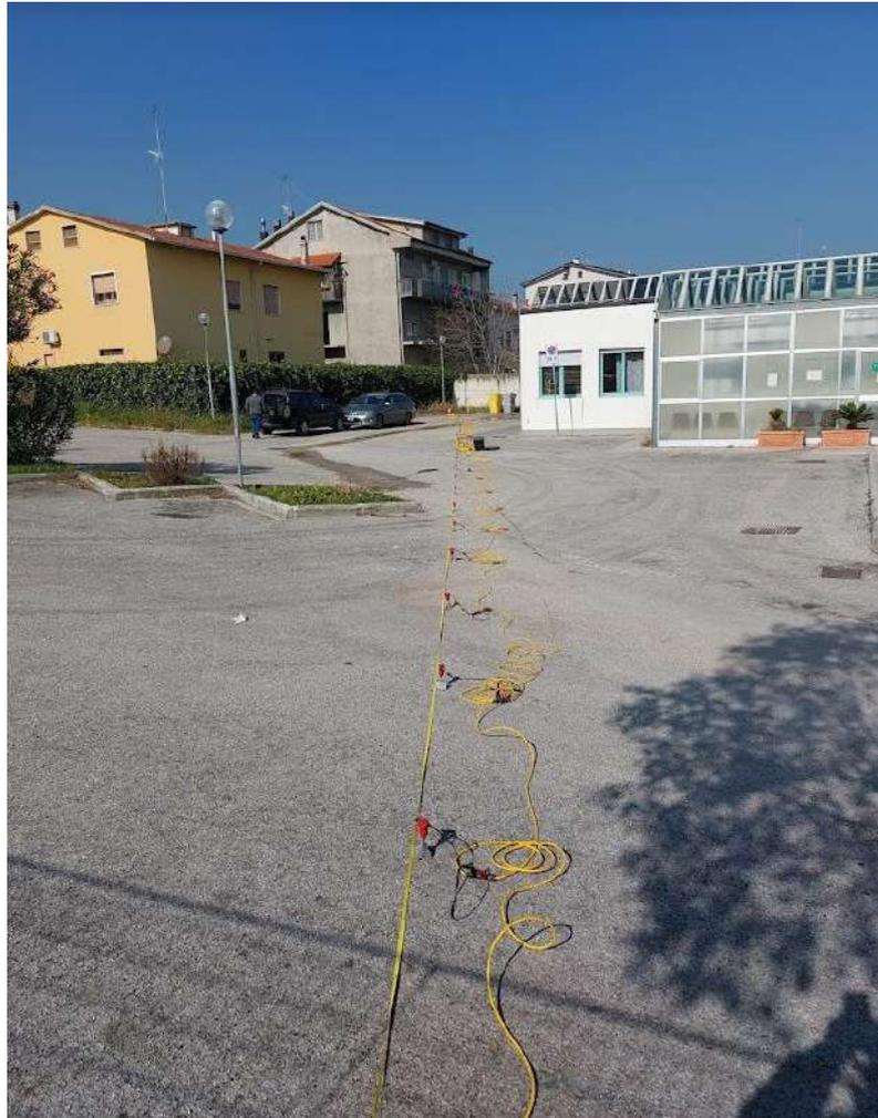
**Figura 12: Stendimento della prova sismica MASW – i geofoni sono poggiati su tripodi.**
