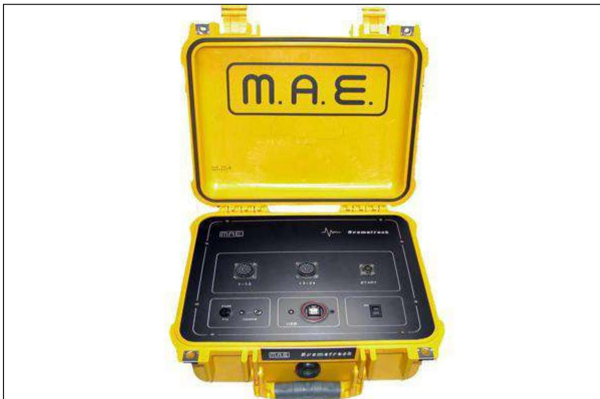
Sismografo 24 bit per prospezione sismica con metodologia di indagine a rifrazione, riflessione, MASW attiva e passiva (Re.Mi.), SASW, Downhole, Cross-hole. L'unità è dotata di scheda di acquisizione con risoluzione di 24 bit ed è disponibile in versione 12 canali espandibile a 24. Sul pannello frontale trovano posto i due
